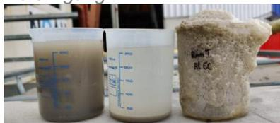
Von links nach rechts: Abwasser, abgereinigtes Abwasser und Floc
